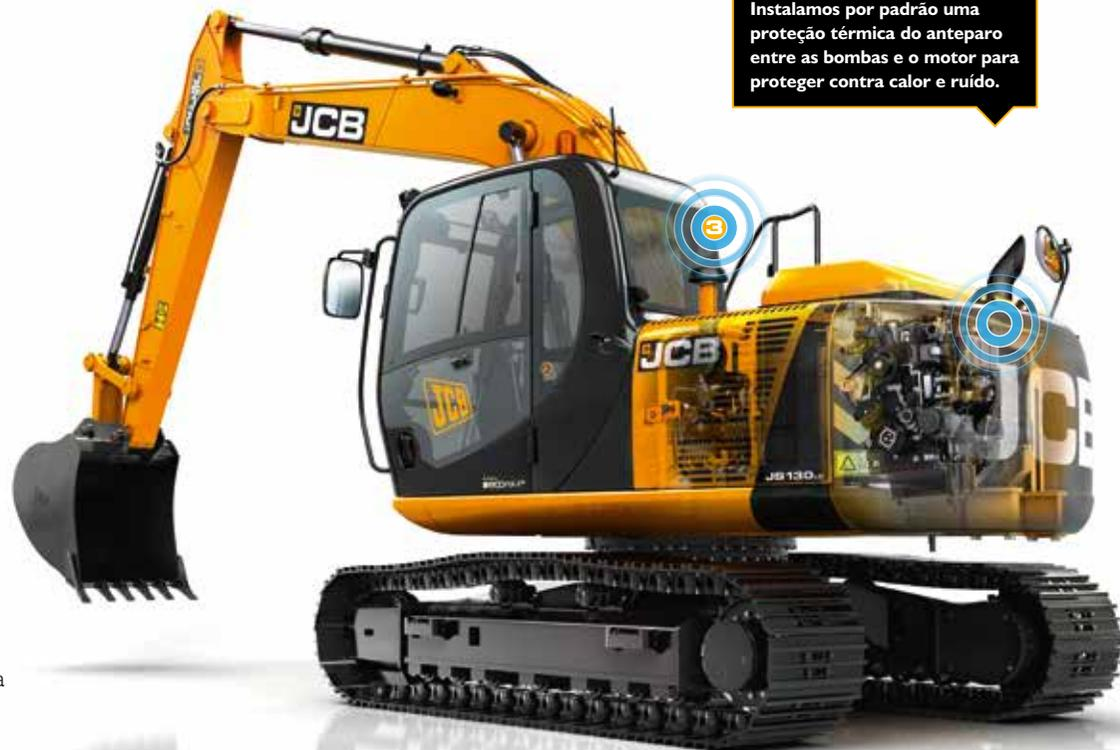
Instalamos por padrão uma proteção térmica do anteparo entre as bombas e o motor para proteger contra calor e ruído.
