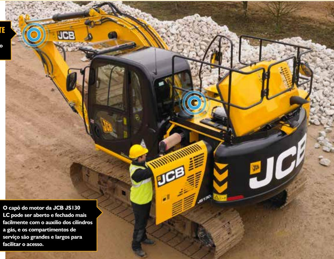
O capô do motor da JCB JS130 LC pode ser aberto e fechado mais facilmente com o auxílio dos cilindros a gás, e os compartimentos de serviço são grandes e largos para facilitar o acesso.
